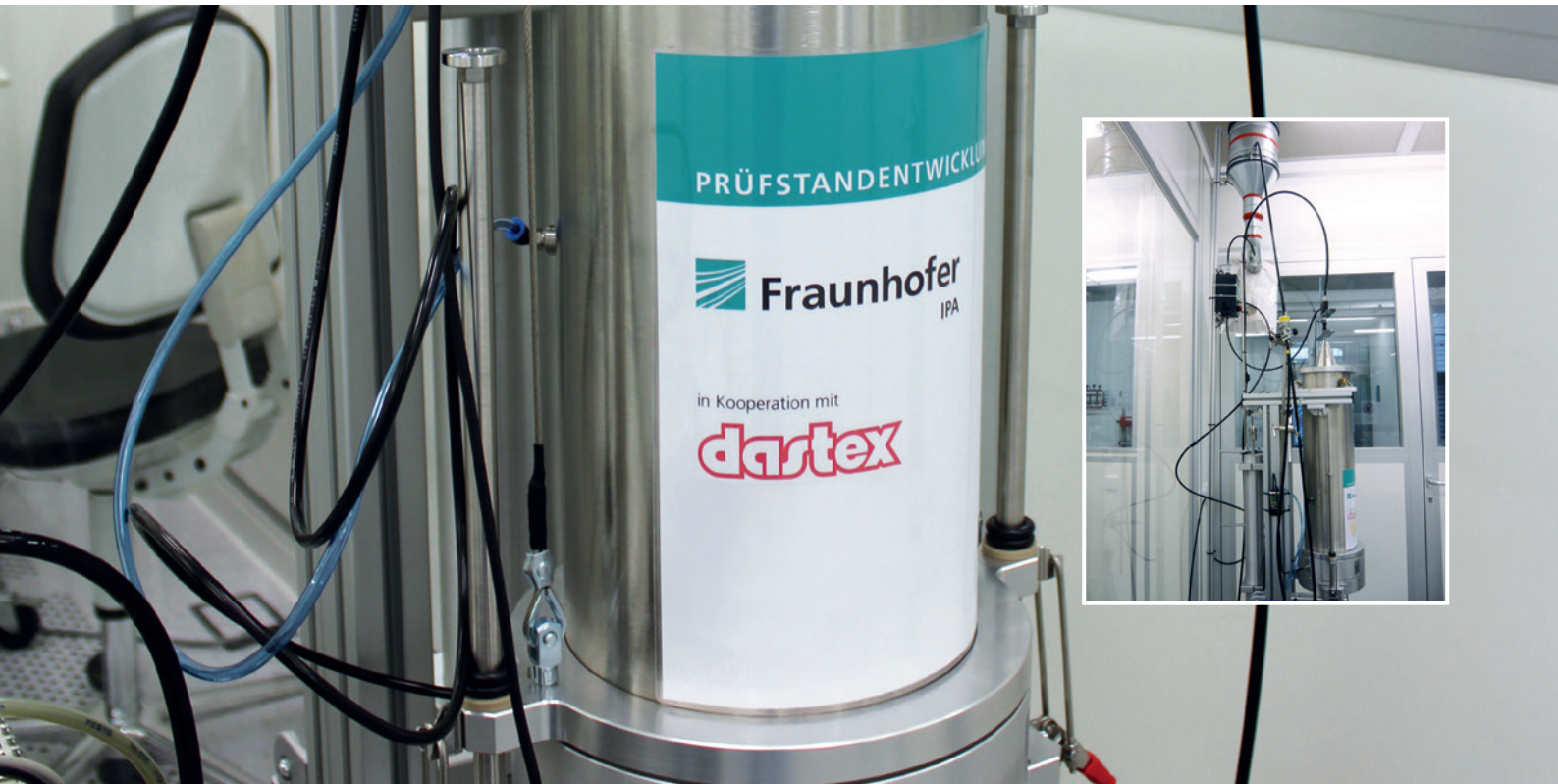
Neuer Filterprüfstand für Reinraumgewebe, eine Gemeinschaftsentwicklung von Dastex und dem Fraunhofer IPA (Stuttgart)
