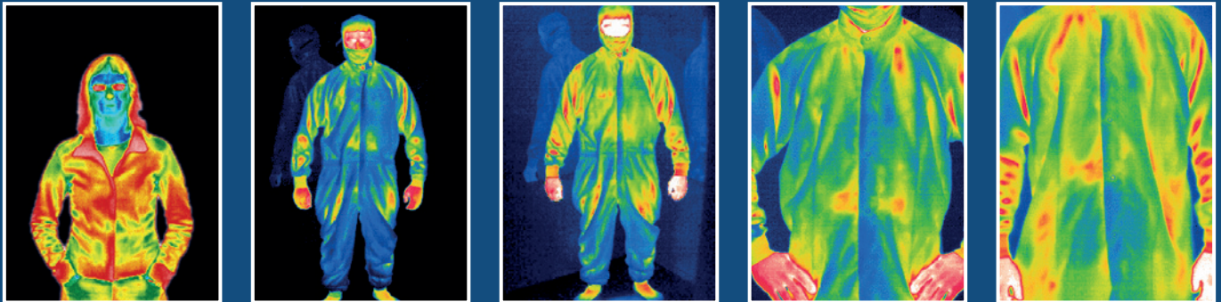
Thermoaufnahmen belegen, dass sich über einen bestimmten Zeitverlauf Wärme unter der Reinraumboerbekleidung aufstauen kann
