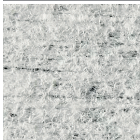
Serie 300 ★ ein Polyester-Zellulose Vliesstoff, typische Oberflächenstruktur
