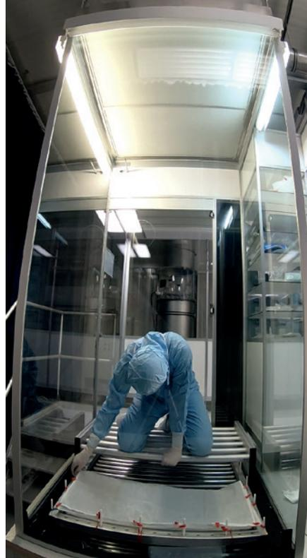
Abbildung 2b: Aufspannen Analysetuch
