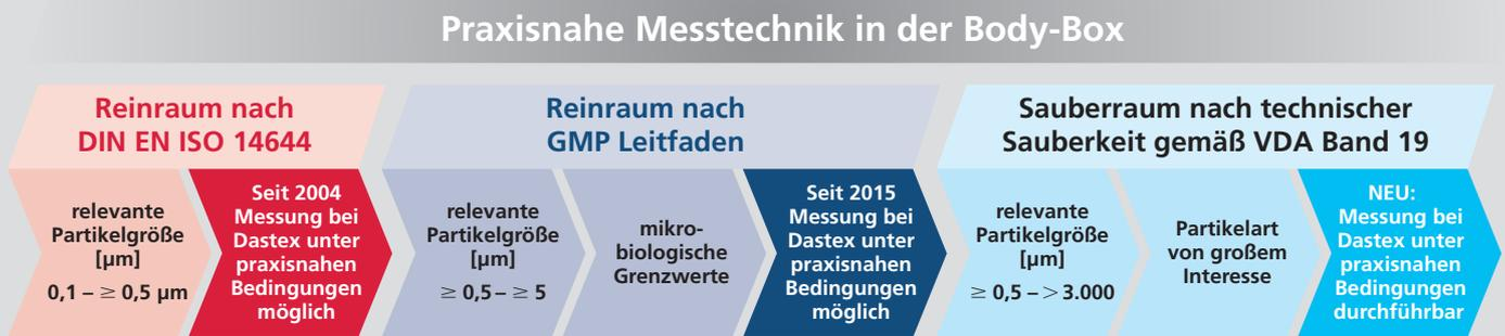
Abbildung 1: Praxisnahe Messmethodik in der Body-Box: Das auf die individuellen Anforderungen angepasste Bekleidungssystem kann ab sofort für alle Bereiche unter praxisnahen Bedingungen untersucht werden.
