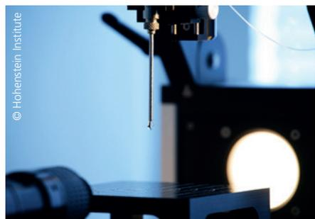
**Abb. 3:** Messung der Benetzungsfähigkeit eines Textils
