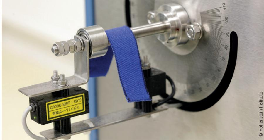
**Abb. 4:** Messung der Biegefestigkeit eines Textils
